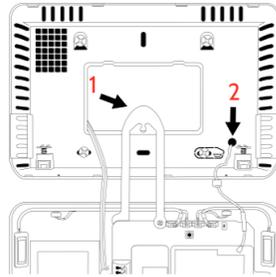
Fixez la plaque arrière sur le mur, puis bouclez la sangle sur le crochet du serre-câble (1). Faites passer l'antenne dans le trou (2)
