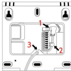
Brancher le bloc d'alimentation (1) et puis attacher le fil à la pince de retenue (2) puis dans le crochet du serre-câble (3)
